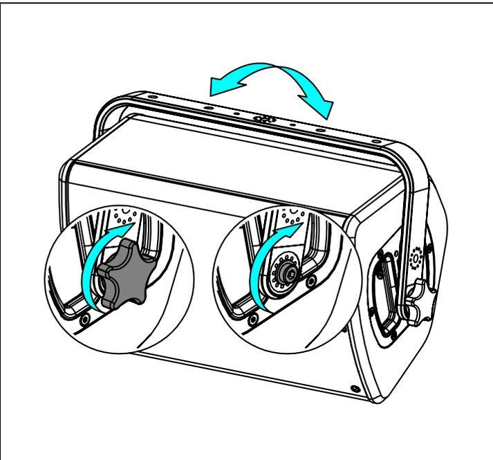
Placer sur CLADAPT, utiliser les 2 guides. Serrer avec la visserie fournie avec le CLADAPT.
