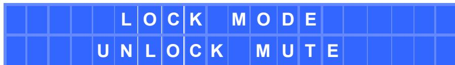
Avec la commande rotative, il est possible de changer le mode de verrouillage souhaité ; puis pressez SHIFT + ENTER pour confirmer la sélection. Si vous sélectionnez un des trois modes protégés par mot de passe (LOCK ALL, UNLOCK OUTS ou UNLOCK INS&OUTS), l'écran suivant demande le mot de passe de verrouillage :
