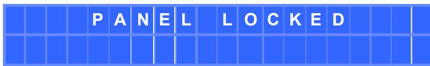
Para habilitar de nuevo los controles del panel frontal es preciso introducir la contraseña almacenada. Para ello, acceda al menú de bloqueo (teclas MENU derecha e izquierda simultáneamente, durante 2 segundos). Se mostrará la siguiente pantalla:
