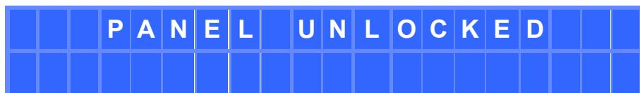
Das Gerät ist jetzt vorübergehend freigegeben, und zwar so lange, bis entweder 2 Minuten vergangen sind, ohne dass irgendeine Einwirkung auf die vordere Bedientafel erfolgt wäre, oder bis sich der Anwender erneut ins Sperrmenü begibt (MENU rechts und links gleichzeitig 2 Sekunden lang gedrückt), um den Sperrmode zu bestätigen oder zu ändern. In diesem Fall wird erneut die Eingabe eines Passworts verlangt (desselben oder eines neuen), welches ab Bestätigung (SHIFT + ENTER) aktiv ist.
