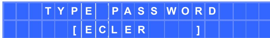
Mit Hilfe eines Drehreglers (ZA bis ZB) wird das ausgewählte Zeichen eingegeben, und mit Hilfe der Taste PARAMETER wird das nächste zu bearbeitende Zeichen ausgewählt. Abschließend wird durch Drücken der Tasten SHIFT + ENTER das eingegebene Passwort bestätigt.
