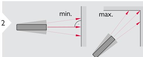
Utilisé pour mesurer en diagonale dans l'espace (valeurs maximales) ou la distance horizontale (valeurs minimales).
