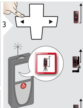
Distance mesurée depuis la face arrière de l'appareil (réglage par défaut).
