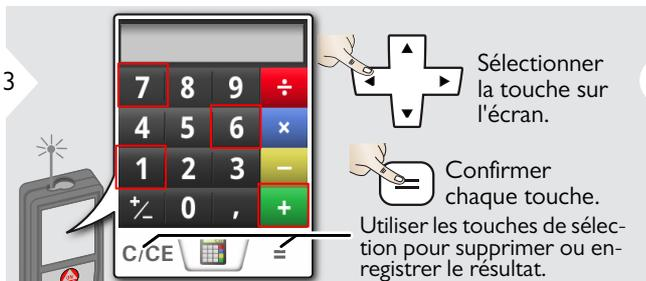
**i** Le résultat de mesure de la ligne principale est repris par la calculatrice et peut être utilisé pour d'autres calculs. Ft/in fractionnaire converti en ft/in décimal.
