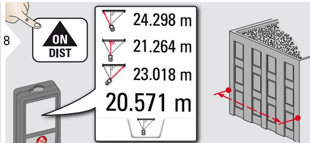
**i** Le résultat s'affiche sur la ligne principale. Si on presse la touche de mesure pendant 2 s, la mesure minimum ou maximum est automatiquement activée.
