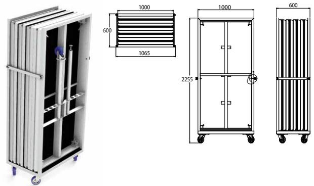
Chariot aluminium permettant le transport de 4 praticables sur la tranche des 1 m
