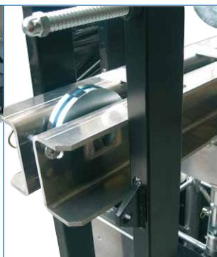
Poulie acier sur roulement pour câble ou chaîne
