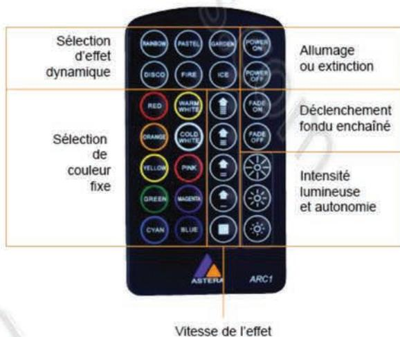
Dirigez la télécommande infra rouge ARC1 vers un ou plusieurs tubes autonomes AX1 positionnés de façon rapprochée, et appuyez sur l'une de touches de la télécommande pour déclencher couleur fixe, cycle ou effet (voir le mode d'emploi complet pour les détails).
