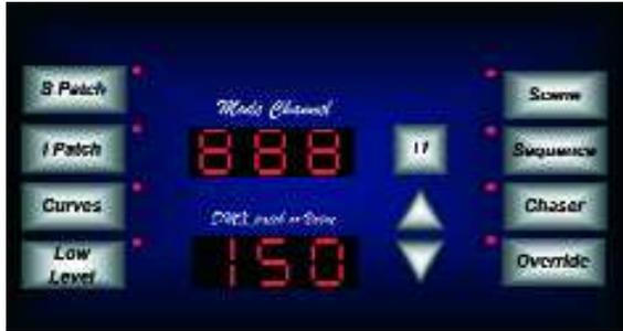
Panneau de contrôle avec 2 afficheurs servant pour la programmation des blocs et la signalisation des défauts.
