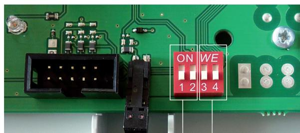
Switchs 1 et 2 pour réglage des fréquences
