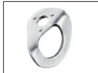
Les plaquettes Petzl sont dotées de reliefs sur leur face arrière qui est en contact avec la structure (béton, rocher...). Ceci empêche la plaquette de tourner lors de la mise en place de l'amarrage, mais aussi à l'usage, lors des fortes sollicitations latérales.
