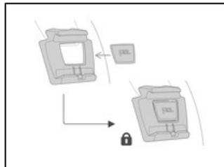
La platine SLOT ADAPT permet de fixer une lampe frontale ARIA sur casque VERTEX ou STRATO.
