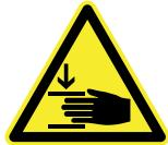
***!Durch die beweglichen Teile besteht Quetschgefahr zwischen den Bauteilen!***
