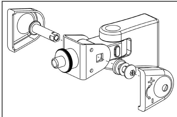
Um den Adapter am Bildschirm-Halter befestigen zu können, muss als Erstes die bereits montierte Bildschirm-Halterung demontiert werden. Hierzu die beiden Kunststoffabdeckungen an der Bildschirm-Halterung abziehen. Die darunter liegende Schraube mit dem mitgelieferten Inbus-schlüssel aufschrauben und die Schraube samt Unterlegscheiben entfernen. Bildschirm-Halterung festhalten und den Bolzen aus ihr entfernen.
