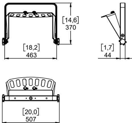
Diamètre des trous de fixation: 11mm – 0.433 inch
