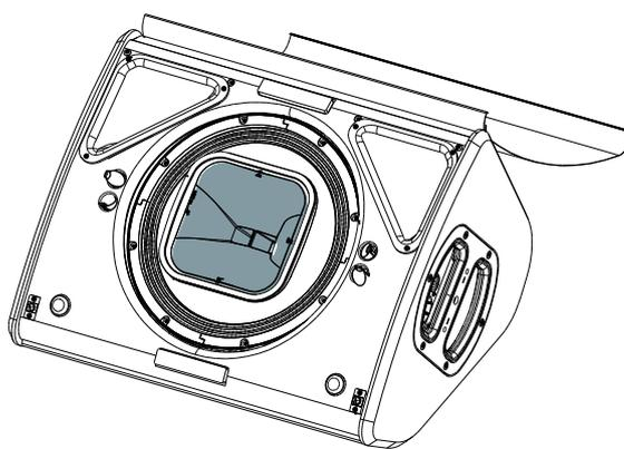
Lors du remontage de la grille, vérifier qu'elle soit bien engagée dans la lame supérieure avant de la fermer à l'aide des vis  $\frac{1}{4}$  de tour.
