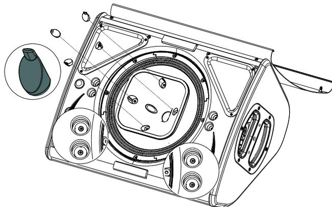
**3** Placer le flange, tourner le si nécessaire.
