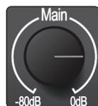
**Main.** Le bouton Main contrôle le niveau des sorties principales (Main Out) gauche/droite à l'arrière de votre Studio 24c et a une plage allant de -80 à 0 dB. Cette commande ne peut qu'atténuer le son.
