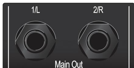
**Sorties principales.** Ce sont les sorties principales de la Studio 24c. Le niveau de ces sorties principales est contrôlé par la commande de niveau Main en face avant de l'unité. Les flux de lecture 1 et 2 sont envoyés à ces sorties.
