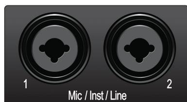
**Entrées microphone.** Votre interface Studio 24c est équipée de préamplificateurs de microphone de haute qualité pour l'emploi avec tous les types de microphones. La Studio 24c possède des préamplis de microphone à semi-conducteurs XMAX-L qui sont optimisés pour l'alimentation par le bus.
