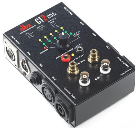
Le CT2 permet d'évaluer facilement le bon état d'une large variété de câbles. Il dispose des connecteurs les plus répandus : Speakon, XLR, Phono Cinch, BNC, DIN, jack stéréo, jack mono, DMX et Banane. Il fonctionne également pour des câbles utilisant des connecteurs différents à chaque extrémité. A l'aide d'indicateurs LEDs et d'un simple bouton rotatif, l'utilisateur peut facilement savoir si le câble est assemblé et fonctionne correctement ou s'il est défectueux.
