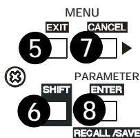
Die Tasten MENU rechts und links (5, 7) erlauben das Blättern in den verschiedenen Seiten der Konfigurationsmenüs des Geräts.
