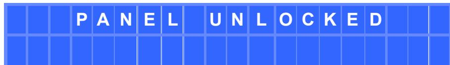
El equipo quedará temporalmente desbloqueado, hasta que transcurran 2 minutos sin actividad sobre el panel frontal o bien se acceda de nuevo al menú de bloqueo (MENU derecha e izquierda simultáneamente, durante 2 segundos) para confirmar o modificar el modo de bloqueo, en cuyo caso se volverá a solicitar la contraseña (la misma o una nueva), que será activa a partir de su validación (SHIFT + ENTER).
