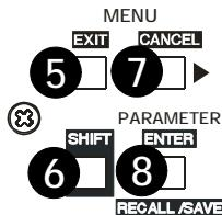
Les touches MENU gauche et droite (5, 7) permettent de naviguer dans les différentes pages des menus de configuration de l'appareil.
