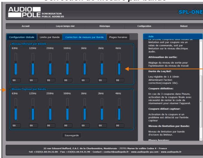
**Correction de mesure par bande :** Uniquement pour le SPL-ONE FB.
