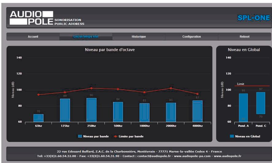
**Leq en temps réel :** Cette page permet de visualiser les différents niveaux acoustiques en temps réel.
