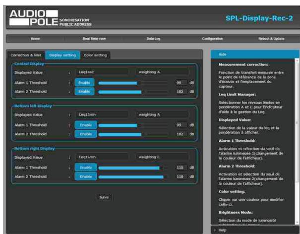
Cette page permet de configurer pour chacun des trois afficheurs les seuils des niveaux sonores indiqués *Alarm 1 Threshold* et *Alarm 2 Threshold*.
