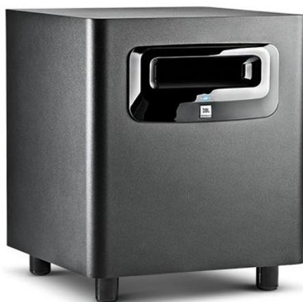
Le subwoofer LSR310S est idéal pour étendre davantage la réponse de votre système d'écoute LSR305 ou LSR308 dans les basses fréquences. Il intègre le système d'évent breveté Slip Stream associé à un haut-parleur 250 mm et une amplification de 200W. Son réglage XLF (Extended Low Frequency) permet d'obtenir une réponse totalement adaptée au mixage Club.
