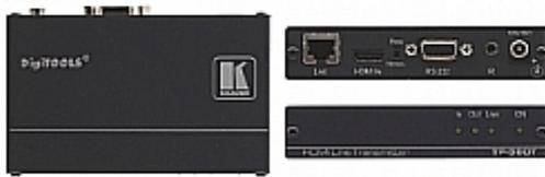
Le TP-580T est un émetteur paires torsadées HDBaseT haute performance pour les signaux HDMI, RS-232 bidirectionnels et IR. Le TP-580T reçoit en entrée des signaux HDMI, RS-232 et IR puis les convertit en un signal paires torsadées HDBaseT vers un récepteur TP-580R.
