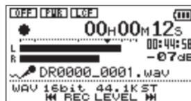
Quand l'enregistrement commence, le voyant d'enregistrement s'allume de façon continue et l'écran affiche le temps d'enregistrement écoulé et le temps d'enregistrement restant.
