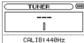
L'écran TUNER contient l'option CALIB pour régler la fréquence du *la* de référence. Pressez la touche ◀◀ ou ▶▶ pour faire monter ou descendre la fréquence du diapason.
