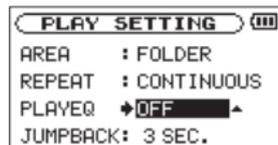
**4** Utilisez la touche + ou – pour régler l'égaliseur. TREBLE (aigus), MIDDLE (médiants) et BASS (graves) indiquent que le réglage des fréquences hautes, moyennes ou basses est activé tandis que + et – indiquent respectivement que le niveau sonore dans cette plage de fréquences est augmenté ou diminué.
