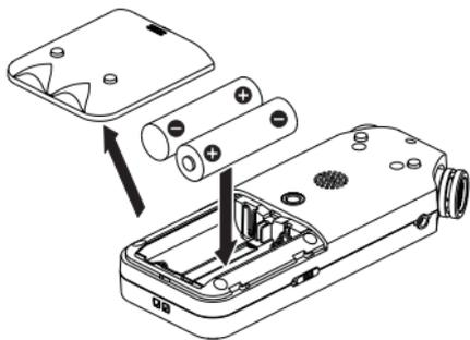
Si vous utilisez des piles AA, réglez le type de pile afin que l'autonomie restante soit fidèlement affichée puisque l'appareil pourra alors déterminer avec précision l'alimentation disponible en vue d'un bon fonctionnement (voir "Réglage du type des piles AA" en page 95).
