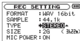
La procédure pour sélectionner la création d'un fichier stéréo ou mono est la suivante. Utilisez la touche + ou – pour sélectionner STEREO (par défaut) ou MONO.
