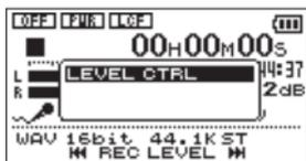
Sélectionnez LEVEL CTRL et pressez la touche ► pour ouvrir la fenêtre locale de réglage de commande de niveau.
