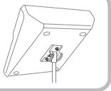
L'appareil peut être installé sur un pied de microphone, comme illustré à droite, en utilisant l'adaptateur pour pied de microphone BMS-10A Yamaha fourni en option. Pour des instructions sur l'installation, consultez le mode d'emploi du BMS-10A
