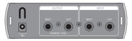
Entrées symétriques gauche/droite (Input). Ces entrées de niveau ligne ne doivent servir qu'à des signaux de sources ne nécessitant pas de préamplification, comme des lecteurs de CD et MP3, tables de mixage et interfaces audio.
